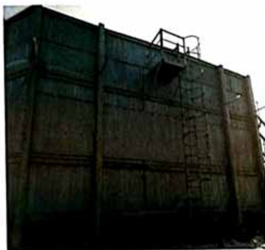
图 4-1 造粒塔粉尘回收装置洗涤除尘系统
