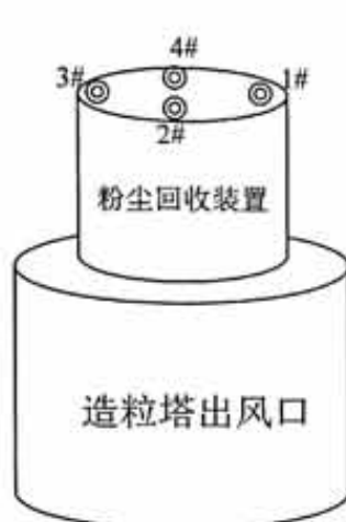
图 6-1 有组织排放废气监测点位示意图
